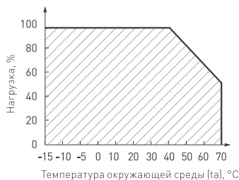
Рис. 2. Максимальная допустимая нагрузка, % от мощности источника
