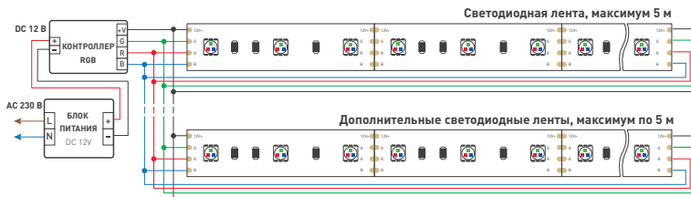
Черный провод — общий «+», красный провод — «R», зеленый провод — «G», синий провод — «B» Схема 2. Подключение нескольких светодиодных лент с двух сторон
